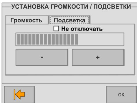
Кнопками «-» и «+» можно задать требуемый уровень громкости встроенного в БИУ TFT звукового сигнализатора и уровень подсветки экрана. Для установки громкости и подсветки переводить ЦБ в режим программирования не нужно.
