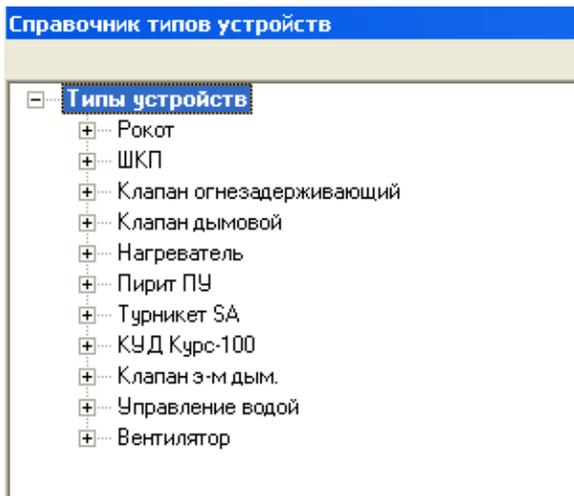
Устройства, добавленные в справочник производителем, находятся в определённых задачах («Оповещение», «Дымоудаление», «Пожаротушение», «Контроль доступа»), и другим задачам принадлежать не могут. Устройства, создаваемые пользователем, могут принадлежать любым (одной или нескольким) имеющимся задачам и/или вновь созданным задачам.
