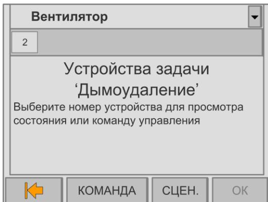
Из выпадающего списка (вверху экрана) можно выбрать необходимое устройство, например, Вентилятор. Для просмотра состояния устройства необходимо нажать на прямоугольник с его номером – откроется информация: номер устройства, название, состояние(я), текущее время, дата.
