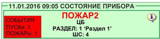
При нажатии на вкладку **СОБЫТИЯ** открывается окно **ПУСКИ, ПОЖАРЫ, Неисправности** с перечнем всех произошедших в системе пожаров и запусков средств противопожарной защиты.
