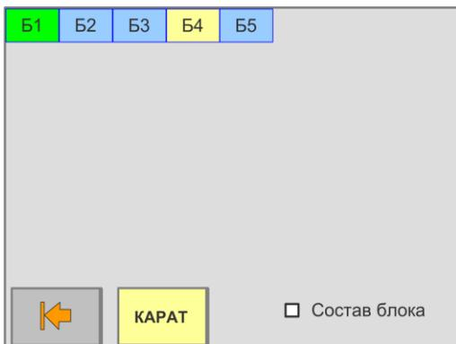
Блоки БШС4(П) отображаются зелёным цветом, блоки БР-4 и приборы управления отображаются синим цветом.
