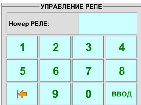
Два вида управления: «Управление по разделу» – включаются/выключаются все реле раздела; «Управление по реле» – включается/выключается одно выбранное реле.
