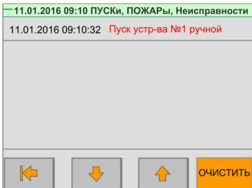
Сброс событий вкладки возможен при нажатии кнопки **ОЧИСТИТЬ** в этом окне или при общем сбросе (перепостановке).
