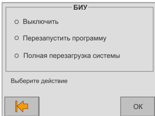
Из этого подменю можно **Выключить БИУ TFT** (производится сохранение всех пользовательских данных + остановка управляющей программы БИУ TFT), **Перезапустить программу** (производится сохранение всех пользовательских данных + перезапуск управляющей программы БИУ TFT) или осуществить **Полную перезагрузку системы** (производится сохранение всех пользовательских данных + перезапуск управляющей программы БИУ TFT + перезагрузка операционной системы БИУ TFT).
