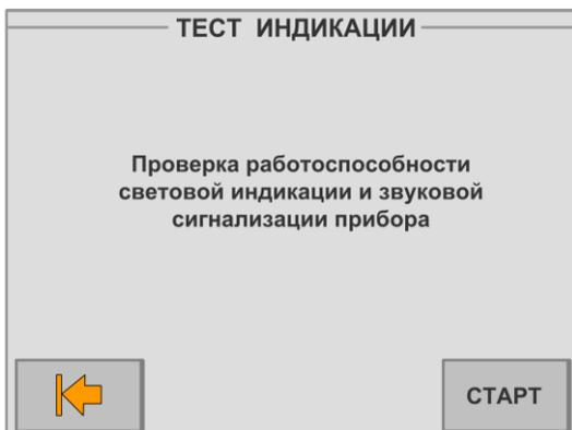
С помощью этого подменю можно произвести тестовую проверку световых индикаторов ЦБ и БИУ TFT и встроенного звукового сигнализатора БИУ TFT. Проверка начинается после нажатия кнопки **Старт** и длится 11 секунд.
