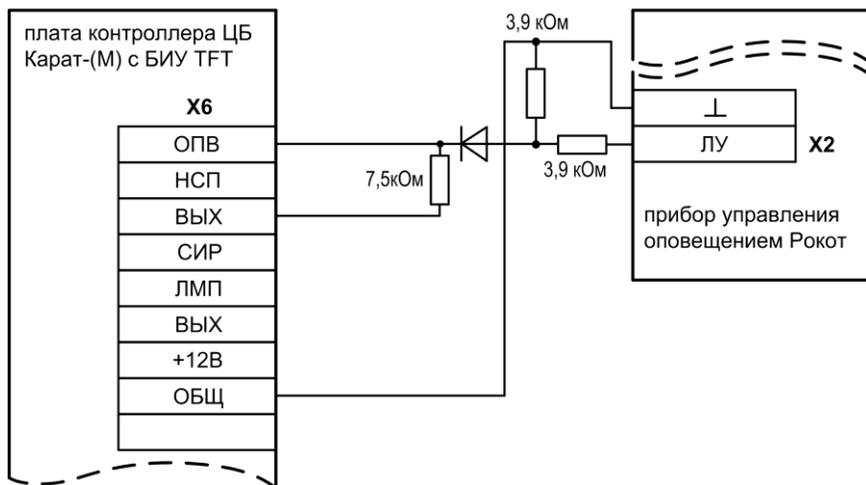
Рис.А7 Подключение прибора речевого оповещения Рокот
