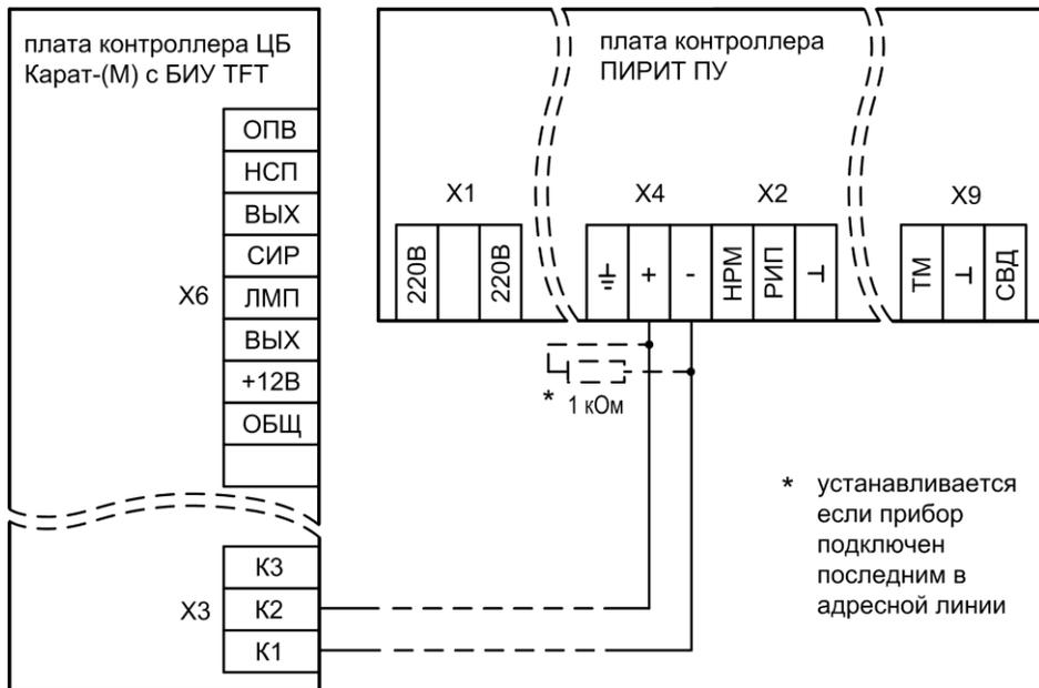
Рис.А16 Схема подключения Пирит ПУ к ЦБ
